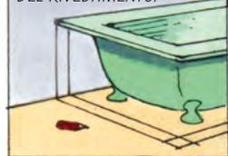
MISURATE L'ALTEZZA DEI BLOCCHI DA TAGLIARE (TENETE CONTO DELLO SPESSORE DELLA MALTA SUL PAVIMENTO, DA 2 A 3 MM).
