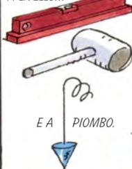
POSIZIONATE UN SECONDO BLOCCO ALL'ALTRA ESTREMITÀ DEL TRAMEZZO E VERIFICATE CHE SIA A LIVELLO. TENDETE UN FILO DI ALLINEAMENTO.
