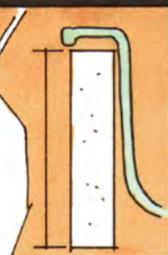
POSATE IL PRIMO BLOCCO INCOLLANDOLO AL PAVIMENTO E AL MURO.
