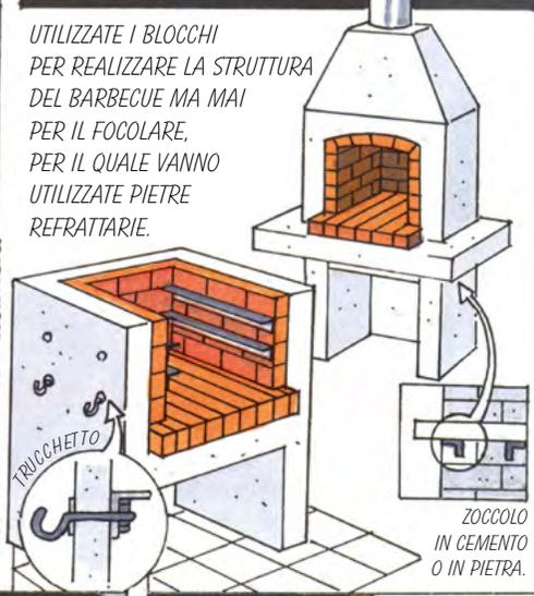
UTILIZZATE I BLOCCHI PER REALIZZARE LA STRUTTURA DEL BARBECUE MA MAI PER IL FOCOLARE, PER IL QUALE VANNO UTILIZZATE PIETRE REFRATTARIE.
